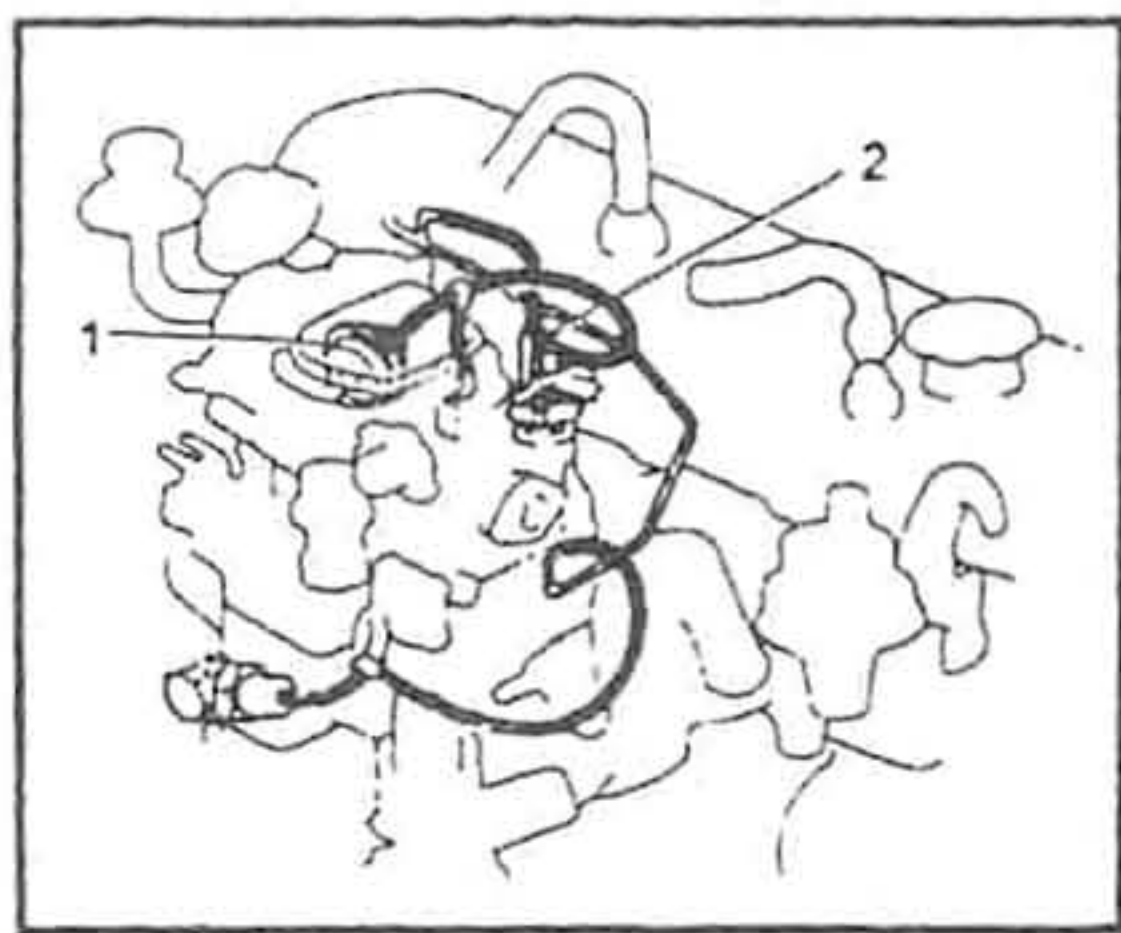
Рис. 416. 1. Диафрагма открывания воздушной заслонки. 2. Би-металлический (или термостатический) клапан переключения вакуума.
